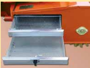
Два сита отделяют крупную и мелкую грязь от засыпного материала
