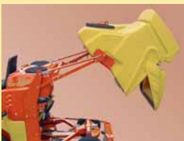
Бункер для мусора с электроприводом для опорожнения
