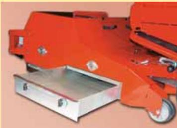
Вибрирующее сито отделяет грязь от материала засыпки и возвращает его одновременно назад
